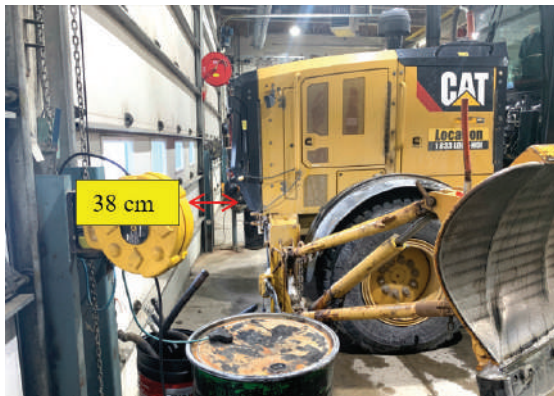
Photo 21 : Dégagement autour du véhicule non réglementaire 14 et non sécuritaire (atelier de BMA)
