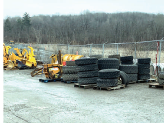
Photo 10 : Pneus gardés à l'extérieur qui ne sont pas protégés des intempéries (atelier de Gatineau)
