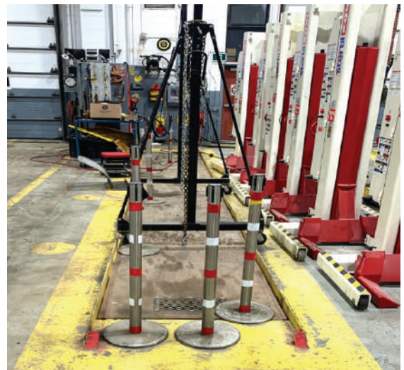
Photo 14 : Fosse d'inspection non fonctionnelle, à droite sont entreposées les colonnes mobiles (atelier de Hull)
