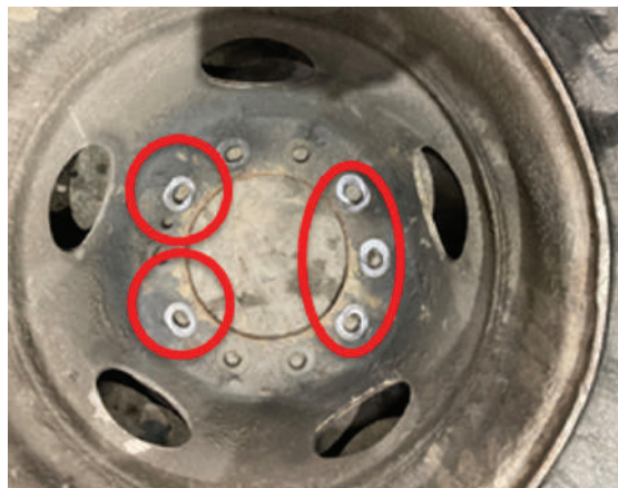
Photo 11 : Roue qui s'est détachée pendant que le véhicule roulait (le gris brillant autour des vis montre clairement le mouvement et l'usure causée lorsqu'une roue n'est pas correctement fixée)
