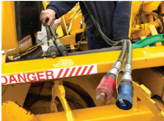
Photo 7 : Véhicule remis à l'extérieur et dont les extrémités des boyaux ont été scellées
