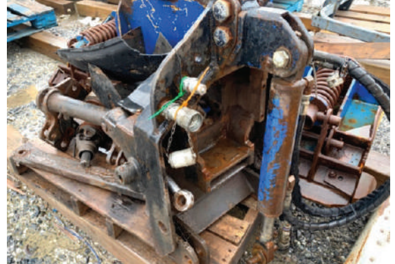
Photo 6 : Équipement remis à l'extérieur dont les composantes internes sont exposées aux intempéries
