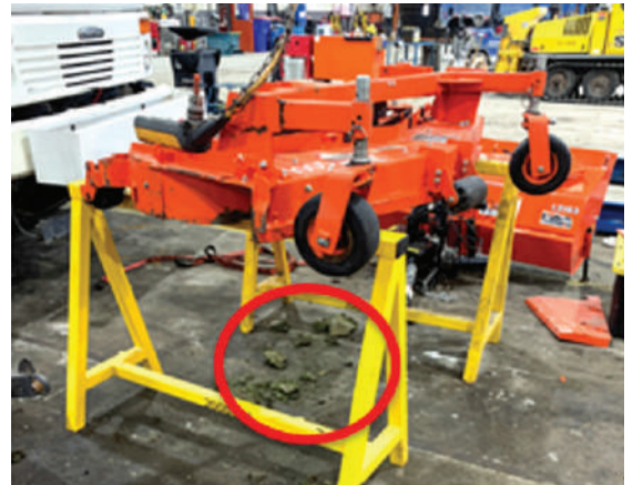
Photo 4 : Le gazon sur le sol montre que la tondeuse a été remise sans être nettoyée
