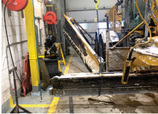
Photo 17 : Dégagement autour du véhicule non réglementaire 13 et non sécuritaire (atelier de soudure de BMA)
