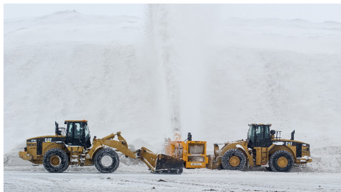
Photo 6 – Mise en pile d'un dépannage avec souffleuse à une phase
