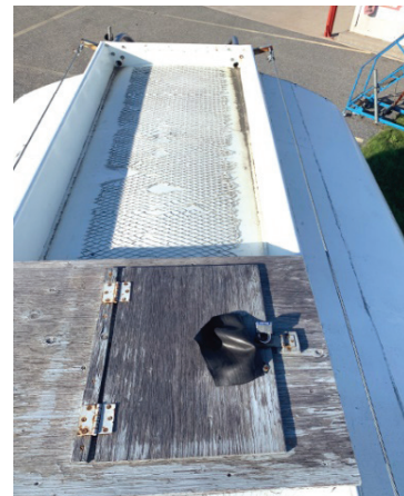
Photo 3 : Boîte cadenassée sur le dessus d'un camion-citerne pouvant être ouverte avec un tournevis
